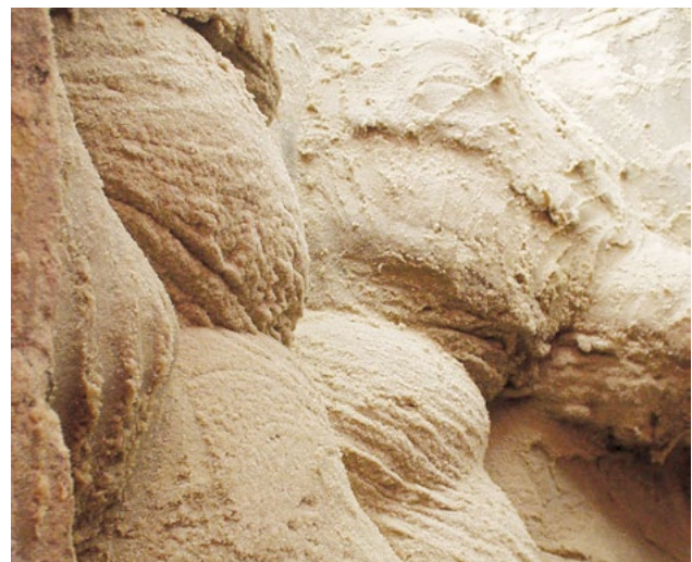
Gel-Sand-Schleier hinter dem Bauteil
