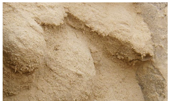
Abb. 6: Beispiel eines Gelschleiers nach der Injektion
