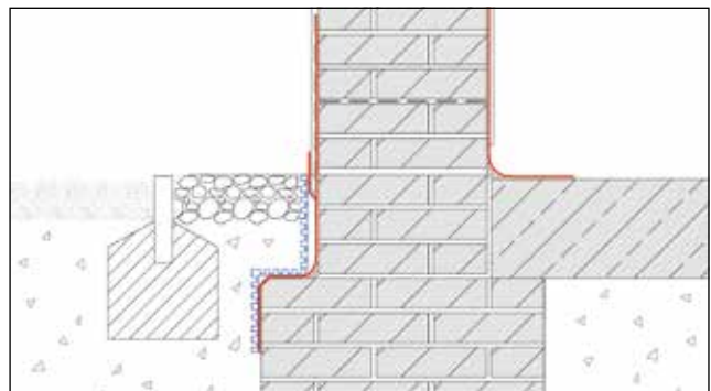
Einschaliges Mauerwerk, feuchte- und salzbelastet
