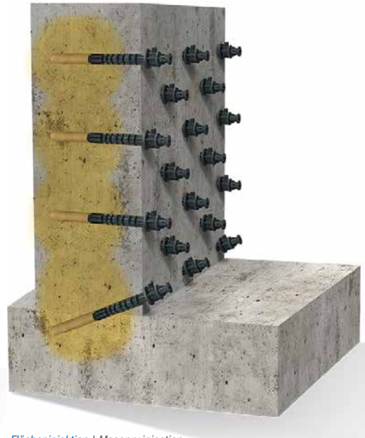
Flächeninjektion | Masonry injection
