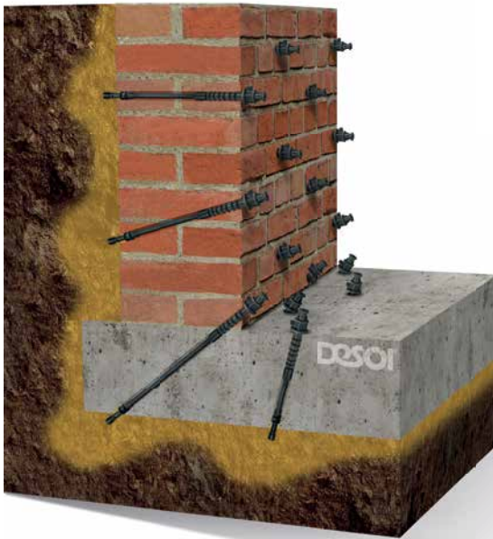
Schleierinjektion | Curtain injection
