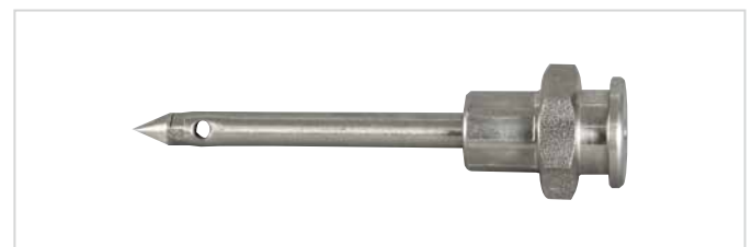
Abbildung 15: Fugeninjektionsnadel (Nr. 23207), Ø 5 mm x 71 mm, Edelstahl, seitliche Austrittslöcher Ø 2,5 mm; Arbeitslänge 25 mm, Anschluss Flachkopfnippel mit Rückschlagventil
