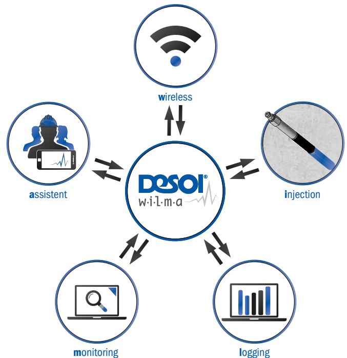
Abbildung 31: Prinzipielle Darstellung der Funktionen des Datenloggers w.i.l.m.a.
