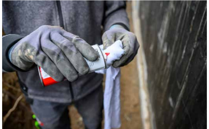
Wischprüfung mit weißem Tuch und Benzin.
